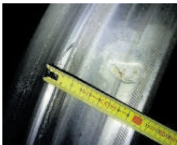
Marcas en una rueda del tren y posible zona de colisión con el carril.
