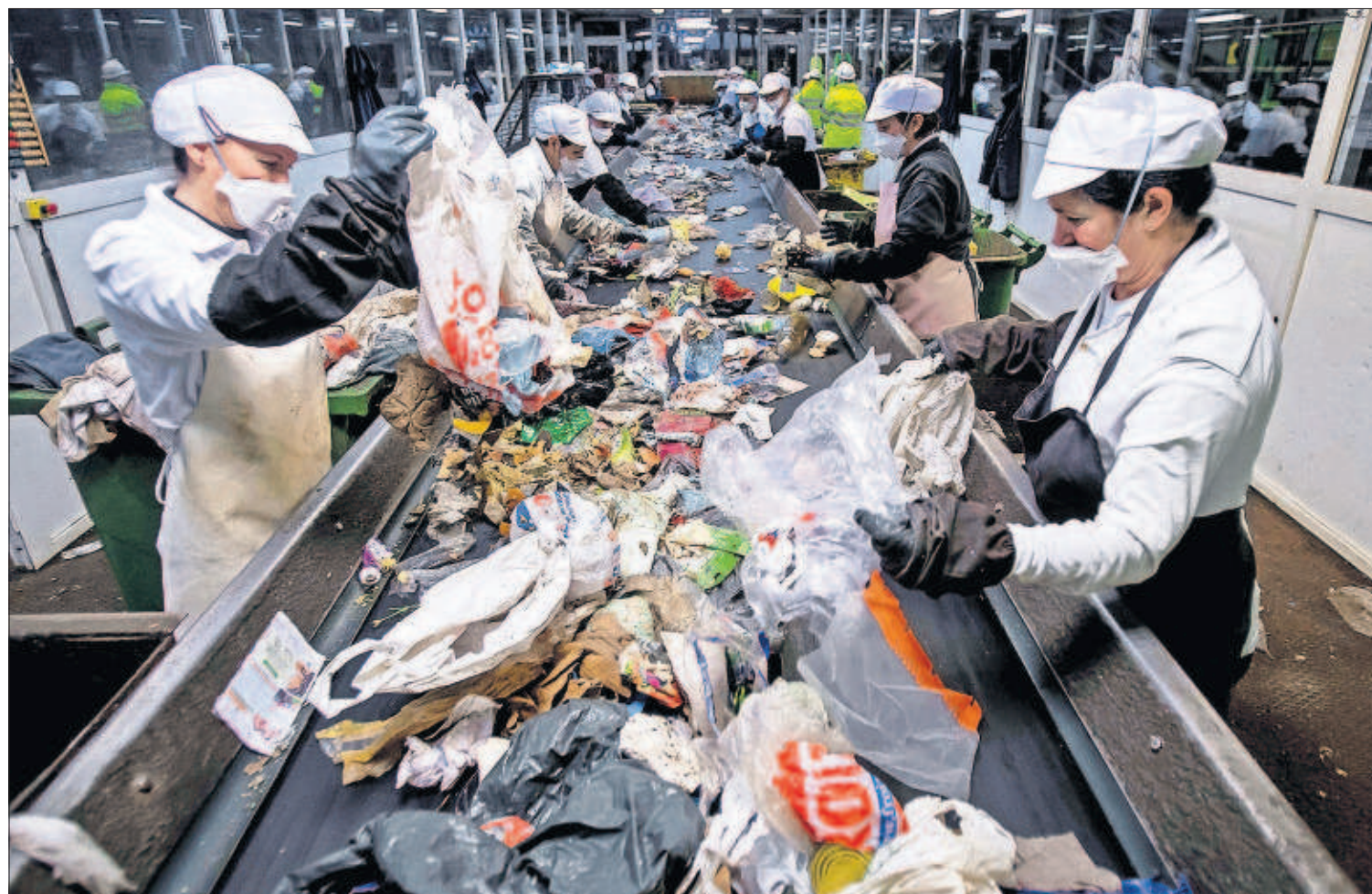
Varias operarias de la planta de basuras de Lousame (A Coruña) trabajan en la cinta clasificadora de materiales reciclables. / ÓSCAR CORRAL
